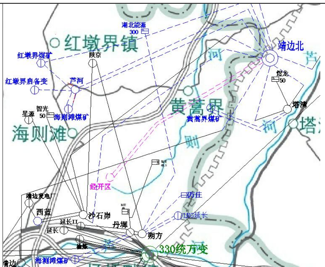
图 1-2 本项目 110kV 变电站接入系统方案图
