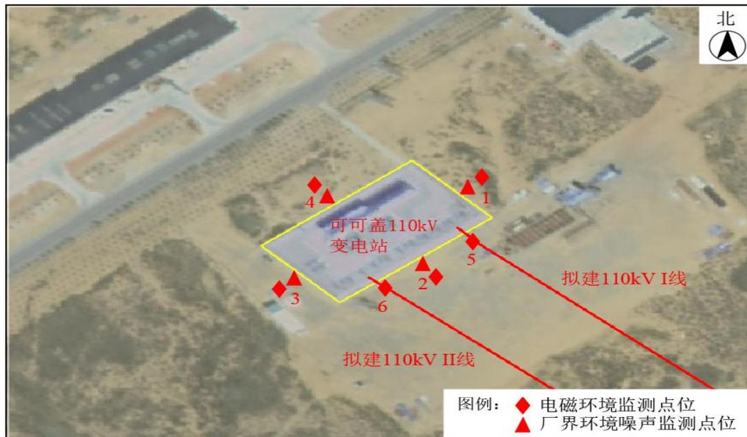
图 3-4 可可盖 110kV 变电站四周厂界及间隔扩建处监测点位示意图
